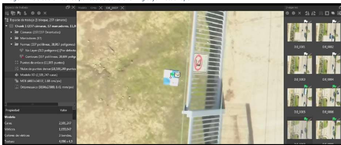
Imagen 2: Ubicación de los puntos de control en Agisoft Metashape
