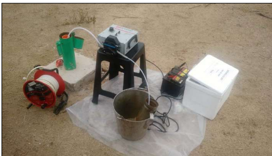
Figura 4: Muestreo de agua subterránea de pozos de monitoreo de la prueba.
