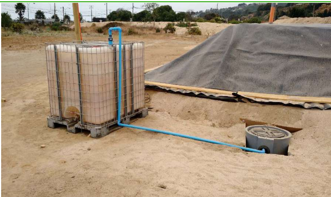
Imagen 9. Sistema de irrigación y recolección de lixiviado.
