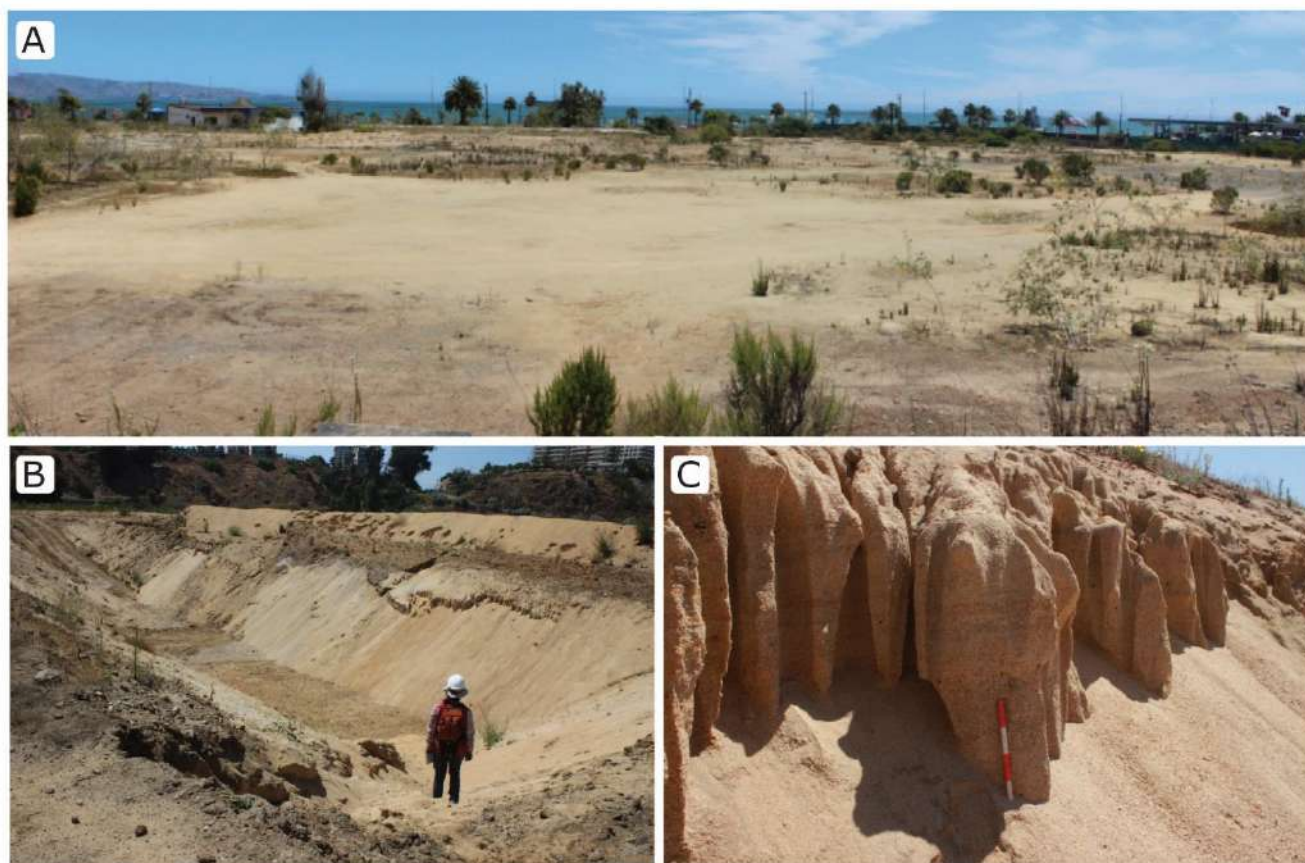
Figura 3-197: Depósitos marinos. A: Vista hacia el oeste del Proyecto. B: Calicata principal punto LS2. C: Litología de arenas medias, con selección buena a regular, características de este tipo de depósito. Se observa una leve estratificación cruzada y formas acanaladas verticales producidas por la erosión, perpendiculares a la estratificación. La escala mide 20 cm (punto LS2).
