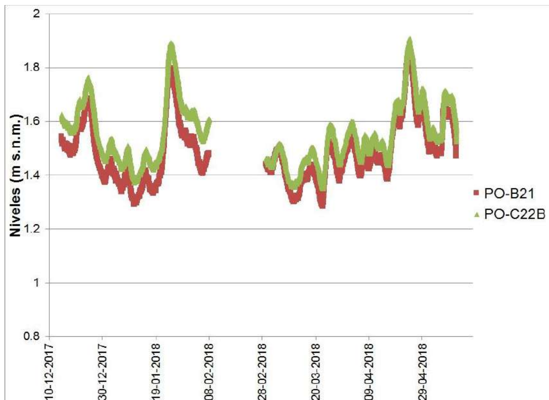
Figura 3-134: Comparación niveles entre pozos PO-B21 y PO-C22B.
