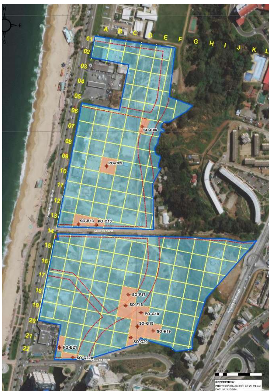
Figura 11: Excedencias de nivel de riesgo para escenario de trabajador de la construcción.
